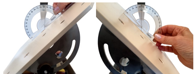
Figure 6. Inclinaison du plateau à +45° et -45°
